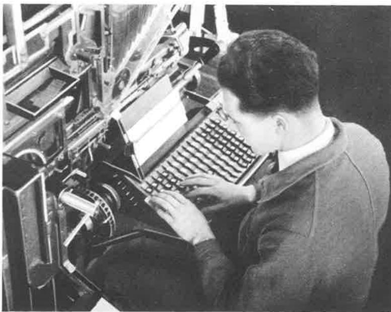
Prunkstück der damaligen Zeit: Ein mit allen neuen Konstruktionen ausgestatteter Linotype-Mixer der Mergenthaler-Fabriken in Berlin, welche monopolmässig die ganze Welt belieferten. Abgelöst wurde der Maschinensatz in den siebziger Jahren durch den Fotosatz.
